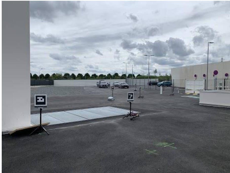
Figure 5 : Valet Parking avec capteurs de perception embarqués sur le véhicule/ infrastructure avec Aruco codes - VMTC
