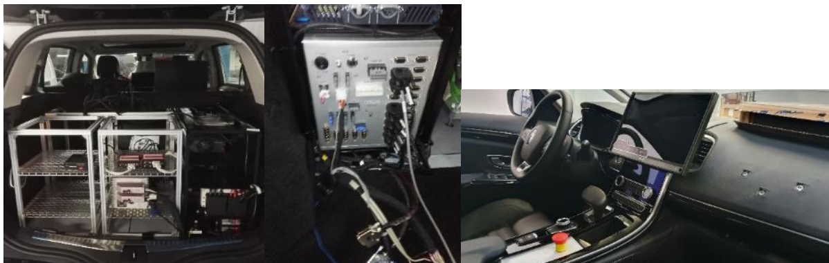
Figure 3 : Implantation des capteurs ADAS dans le véhicule Renault Espace
