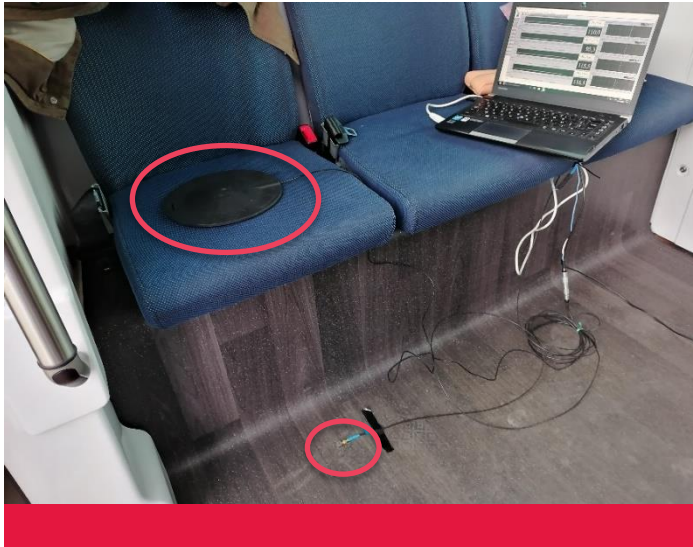
Instrumentation de l'habitacle avec des accéléromètres tri-axe
